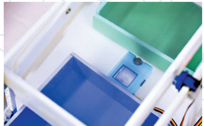
底層以透明膠片設計，令底部鏡頭掃描紙張反面有否油墨。
